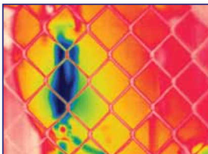
Системы с пассивной автофокусировкой часто захватывают предмет в ближней зоне, в данном случае забор из проволоочной сетки.
